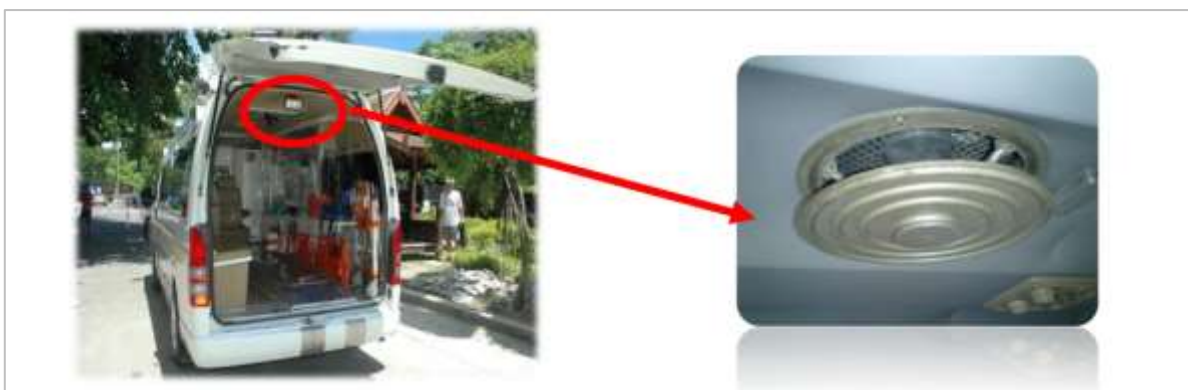
ภาพที่ 7.1 ระบบระบายอากาศในรถที่ใช้เคลื่อนย้ายผู้ป่วย
