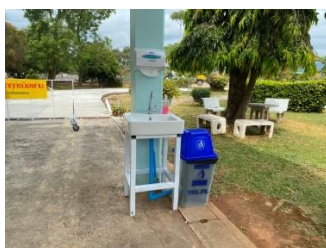
นวัตกรรมเครื่องกดเจลล้างมือแบบเท้าเหยียบ
